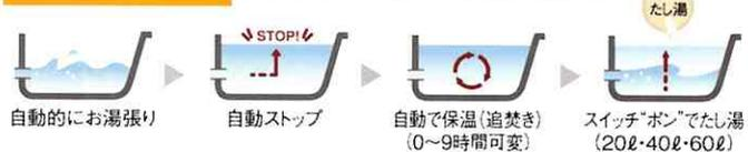
お湯が設定水量に達するとお湯がストップし、自動保温。給湯運転・ふる自動運転・おいだき運転の全てがワンタッチ操作。
